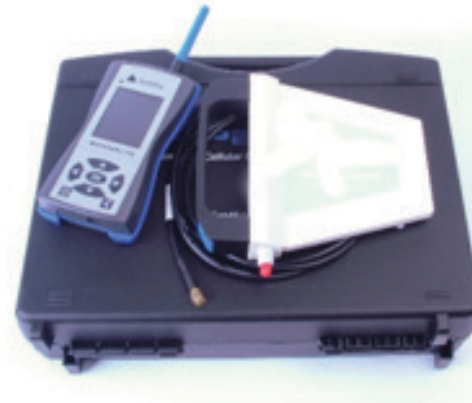
איור 3. מכשיר ה-SNYPER LTE SPECTRUM מסופק עם אנטנה פריקה, אנטנה כיוונית (LiveScan) ומזוודה קשיחה
