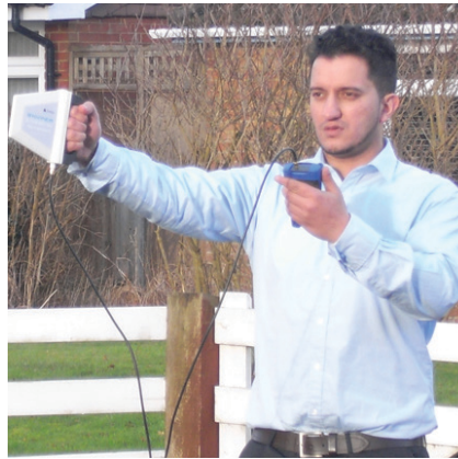
איור 2. חיבור אנטנה כיוונית (LiveScan) למכשיר ה-SNYPER למציאת כיוון אופטימלי
